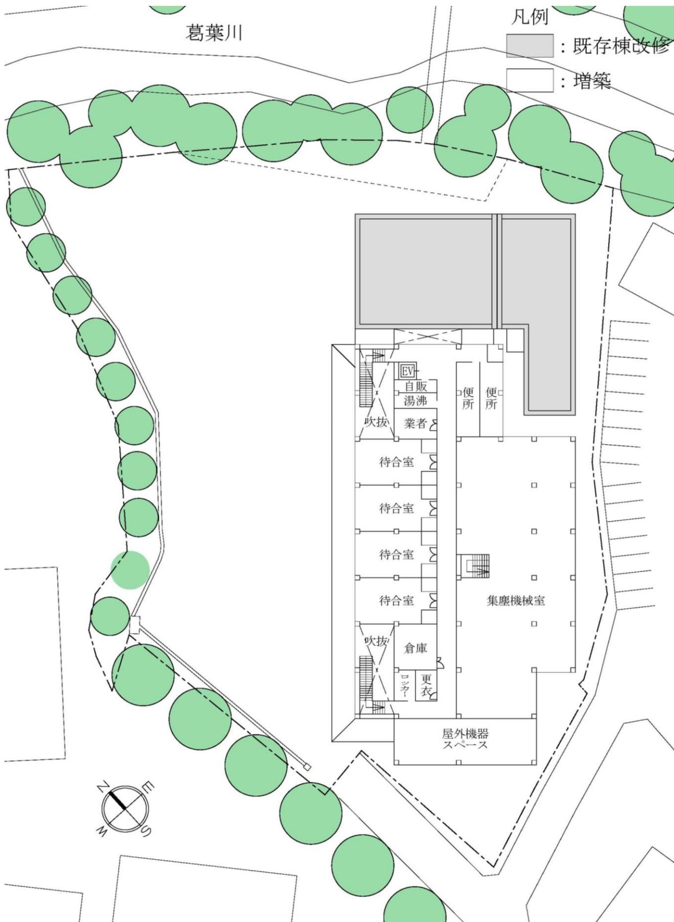
図5 B案2階平面図 (S=1/500)
