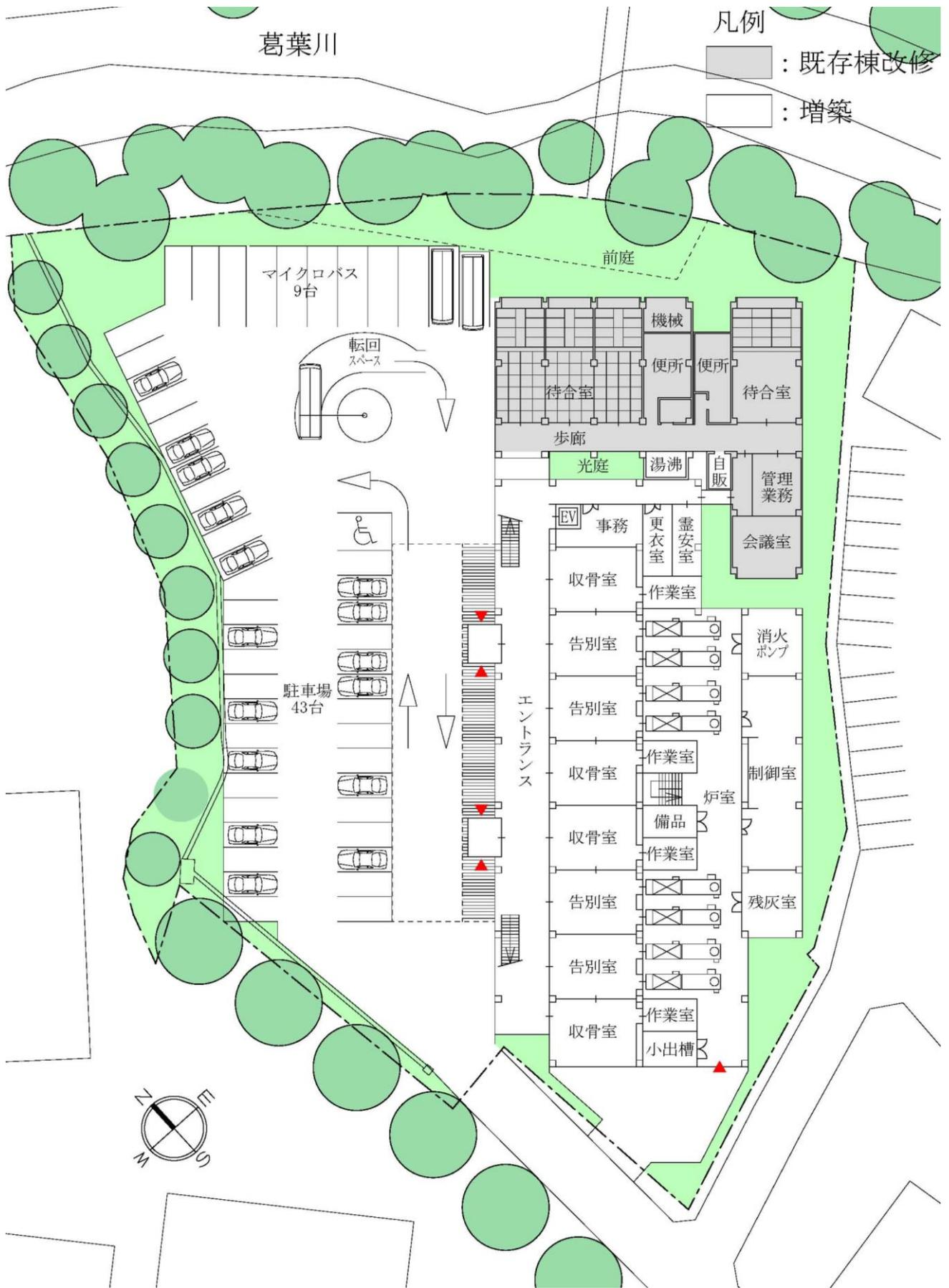
図4 B案1階平面図 (S=1/500)
